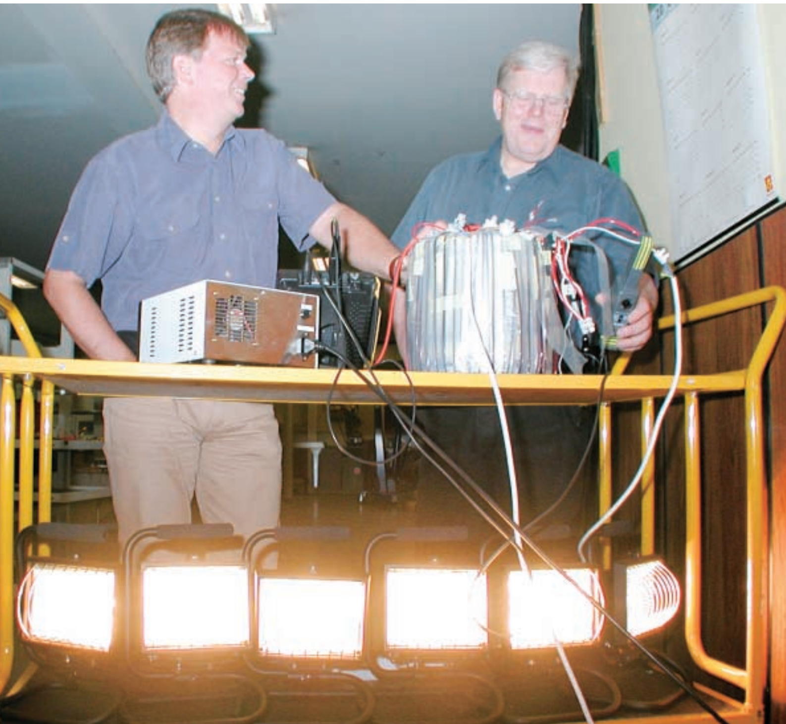
OMFORMER UTEN HALVLEDERE: Espen Haugs (t.v.) og Frank Strand tester en frekvensomformer uten halvledere, som kan brukes der datateknologi kommer til kort på havets bunn. Demonstrasjonsanlegget brukes her til å styre lysstyrken fra halogenlampene.
