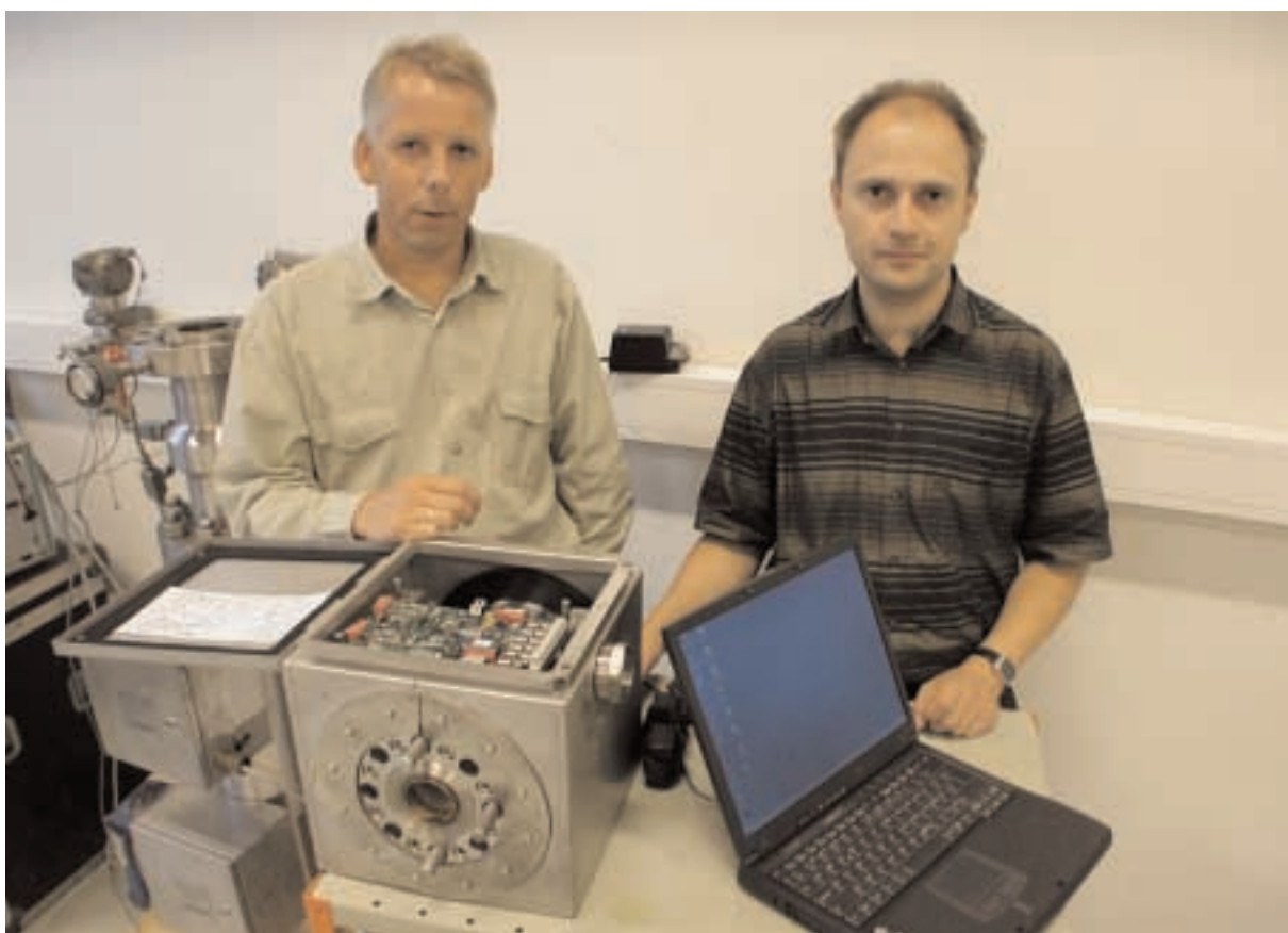
SENSOREN: Eivind Dykesteen og Kristian Eckhof med sensoren som kan koples på borestrenger dypt ned i produksjonsbrønnene.
