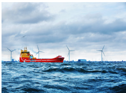
Viking Lady er et hybridskip og har både batteripakke, brenselcelle og drift med flytende naturgass (LNG-drift). Foto: Kjell Sandaker, Eidesvik.
